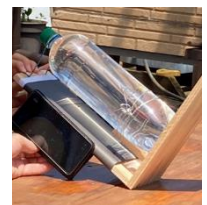
図8. 携帯アプリを使用して固定器具に角度をつけるようす
