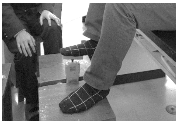
Fig. 2 デジタルフォースゲージによる踏む力の計測
