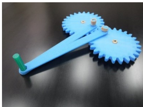
Fig. 5 リンク機構と歯車の直線運動機構
